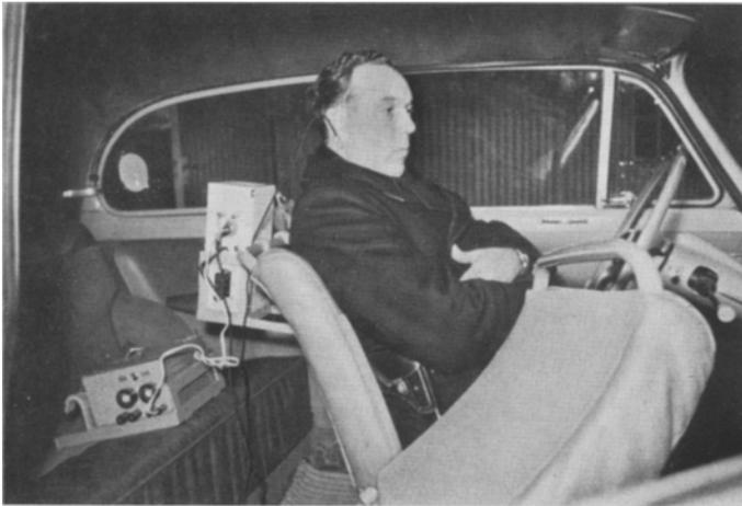
Abb. 2. Testfahrer mit angeschlossenem Pulszähler und Druckzählwerk
